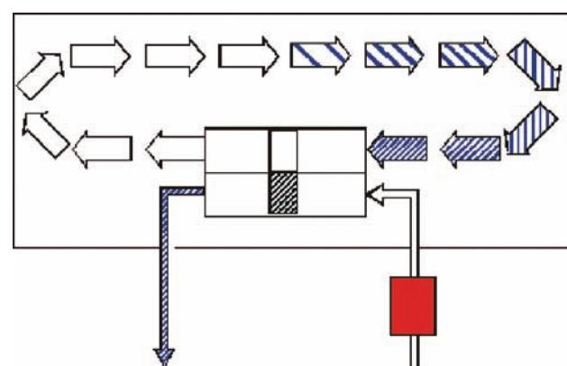
Рис. 2. Адсорбционный метод осушения
